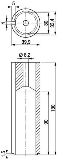
**Gewindespindel** Werkstoff: Stahl
